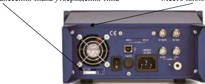
Рисунок 14 - Места для размещения наклеек на примере задней панели анализаторов цепей векторных С1209
