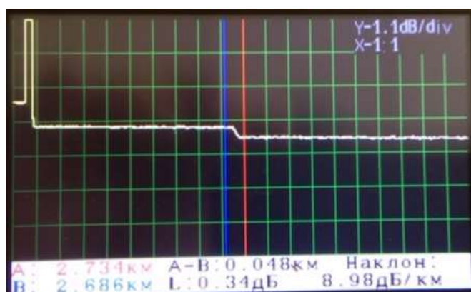
Рис. 15 Измерение затухания на неоднородности
