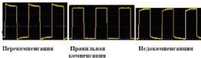
Рисунок 3-7 Варианты осциллограммы при компенсации пробника
