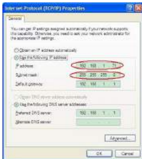
Рисунок 7-2 Установка сетевых параметров компьютера
